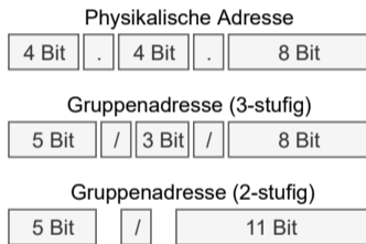
Abbildung 5: Addressierung von KNX-Geräten
