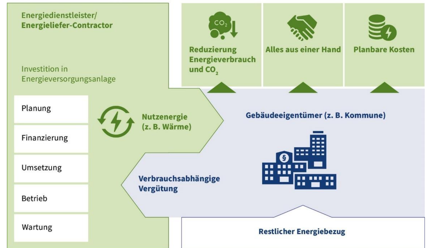
Funktionsprinzip Energieliefer-Contracting (ELC)
